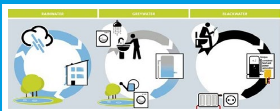
De drie kringlopen van de 'Hamburg Water Cycle'. Bron: Hamburg Wasser
