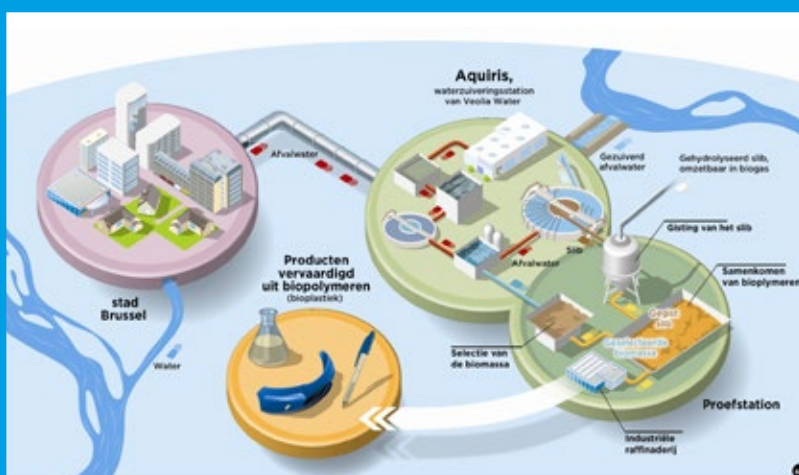
Schematische weergave van de herwinning van bioplastic uit afvalwater door Véolia bij de stad Brussel
